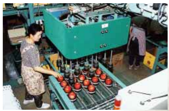
光センサーによる選別。厳しい品質管理が「江刺ブランド」を保証しています。
